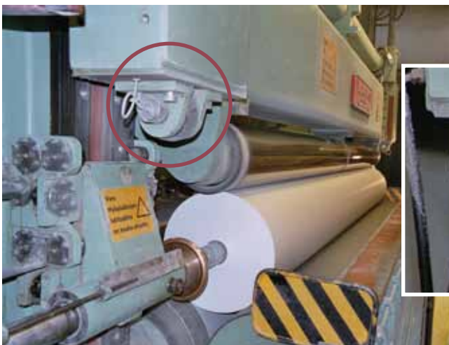
Kraftaufnehmer KISD, in der Druckwalze montiert
